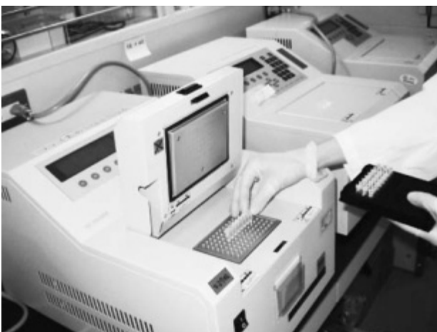
写真4. DNA 増幅装置（PCR）
