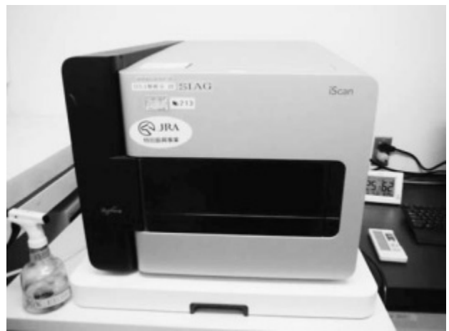
写真 9. DNA チップの情報を読み取る装置
