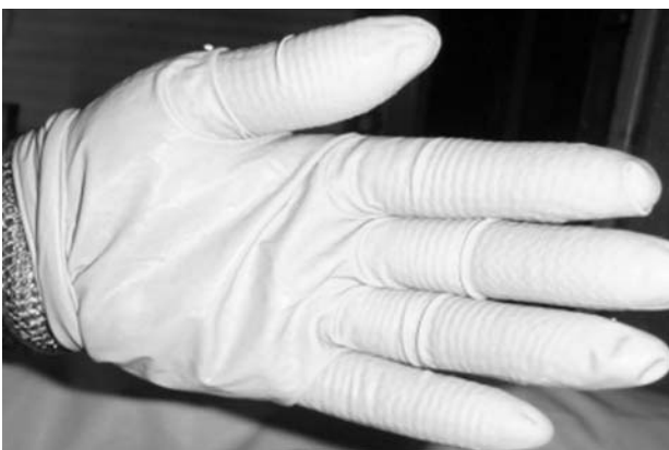
写真2 メッシュグローブの上に装着したニトリル手袋 アクリロニトリルと1、3-ブタジエンとの共重合体がニトリルゴムで、これを原料とした耐油性、耐摩耗性、引き裂き強度に比較優れ、安価な使い捨てゴム手袋
